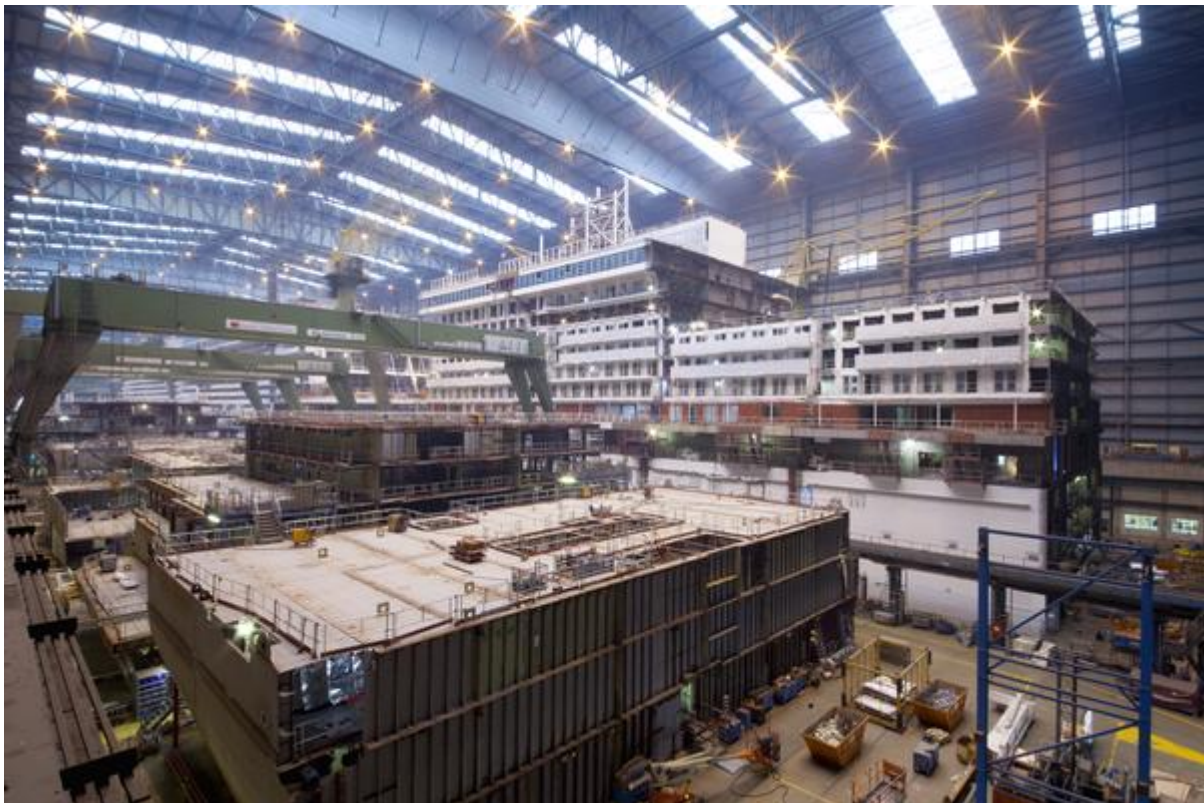
Blick in das Trockendock der Meyer Werft, wo parallel an zwei Kreuzfahrtschiffen gebaut wird. Foto: Michael Wessels
